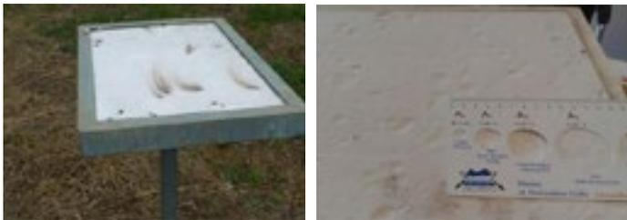
Figure 2 : Grélimètre permettant d'évaluer l'intensité des épisodes de grêle (à droite - Plaque d'Ars au 9/6/14)
